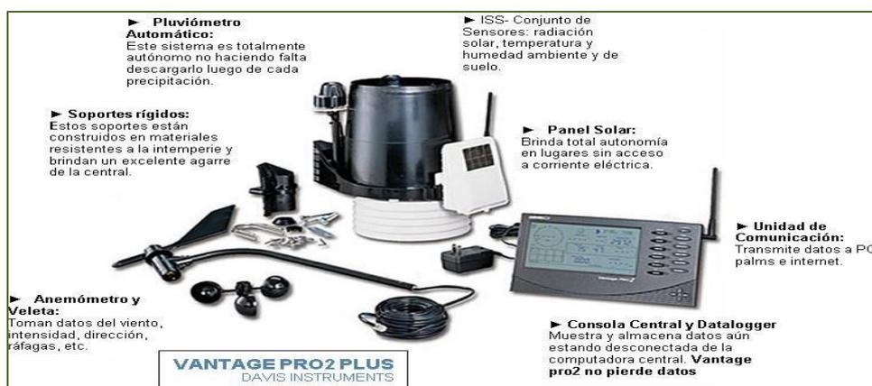
Ilustración 36. Estación climatológica tipo (Fuente: Davis Instruments)
